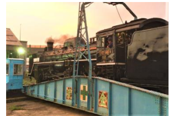
転車台を使用した方向転換作業
