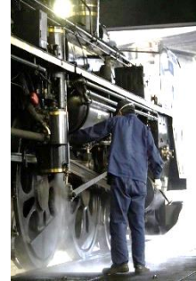
出区点検作業
